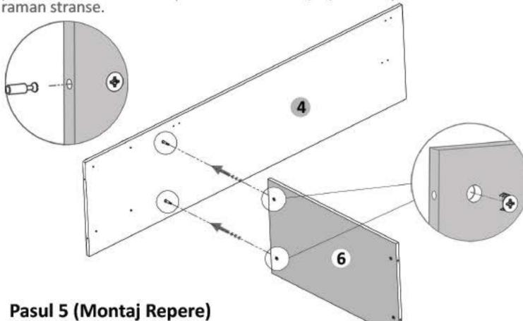
Se prinde placa (6) de placa (4) cu demontabili (De) x 4 buc in gaurile prestabilite, urmand ca apoi sa se infileteze (Ca) x 4 buc pana acestea raman stranse.
