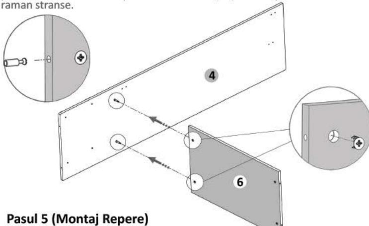
Se prinde placa (6) de placa (4) cu demontabili (De) x 4 buc in gaurile prestabilite, urmand ca apoi sa se infileteze (Ca) x 4 buc pana acestea
